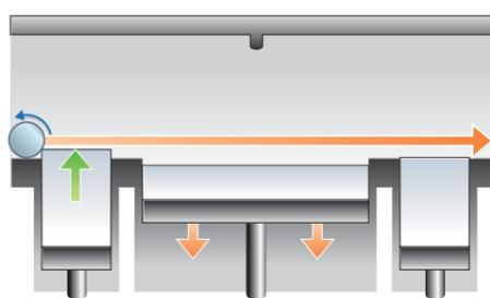
造形エリアが一層分下がる。樹脂供給エリアが上がり、持ち上がった樹脂をローラーを使って造形エリアに供給する。
