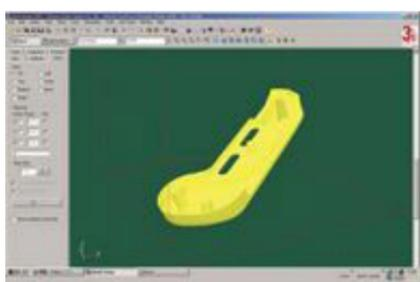
3次元CADデータをSTLに変換したのち、レイアウト、造形条件設定を行い、造形機に読み込ませる。
