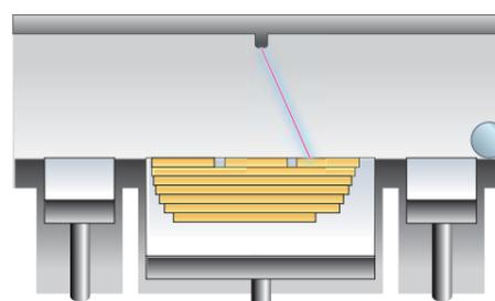
樹脂供給、レーザー照射を繰り返して、焼結させた樹脂を積層させて造形を行う。
